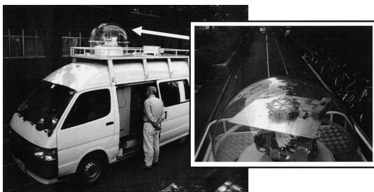
図 14 実験車の屋根に搭載されたアンテナと半球状レドーム
