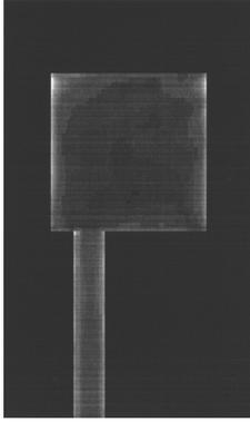
図 4 パッチアンテナ上の電流分布
