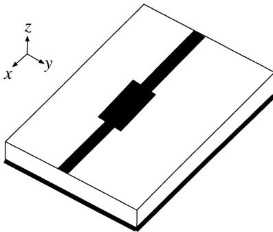
図 1 誘電体基板上マイクロストリップ線路
