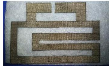
図 10 試作した RFID タグ
