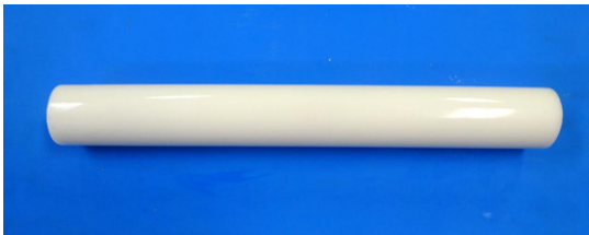
図 13 2/3 筋肉等価ファントム Fig.13 2/3 muscle-equivalent phantom.
