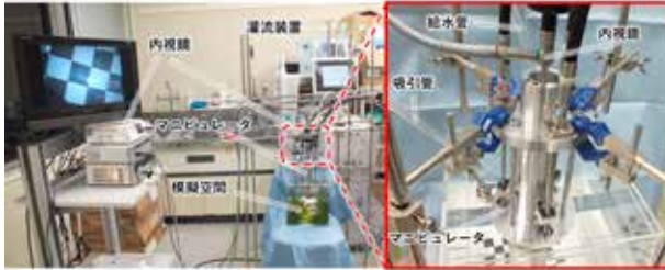
WaFLES支援用空間確保ロボットシステム Surgical workspace creator for WaFLES
