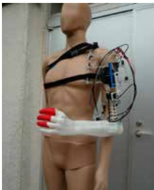
5自由度肩義手 5 DOF Shoulder prosthesis
